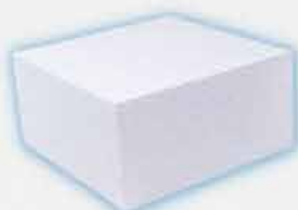
EPS BLOCO PREENCHIMENTO
